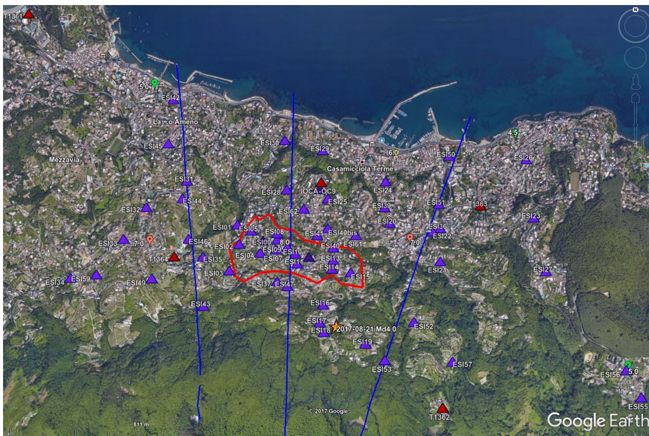
Fig. 1. Misure di rumore sismico eseguite a Casamicciola Terme e a Lacco Ameno (triangoli viola). Le stazioni sismiche temporanee SISMICO e le stazioni della rete dell'Osservatorio Vesuviano sono rappresentate dai triangoli rossi. Le linee blu indicano la proiezione in superficie delle sezioni geologiche/stratigrafiche di dettaglio seguite per l'installazione di parte delle stazioni temporanee. La linea rossa delimita la zona rossa di Casamicciola Terme (Azzaro et al., 2017), i fumetti di diverso colore rappresentano l'intensità macrosismica associata al terremoto di Ischia del 21 Agosto 2017 la cui posizione epicentrale è rappresentata dalla stella arancione (Gruppo di Lavoro INGV sul terremoto dell'isola di Ischia, 2017).
